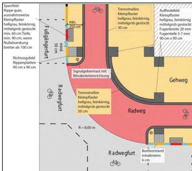
Abb. 36: Empfehlung – differenzierte gesicherte Querung mit Radweg auf Gehwegniveau
